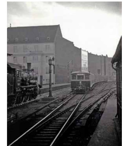
Abb. 1: Sichtbarer Ausdruck der »Großen Elektrisierung«: 1935 begegnen sich die Betriebsarten am Bahnhof Zoologischer Garten: S-Bahn 28/30 Typ Stadtbahn mit einer Lokomotive P8 Baureihe 38, Foto: Ewald Gnlika, Landesarchiv Berlin, F Rep. 290 (02) 0172556
